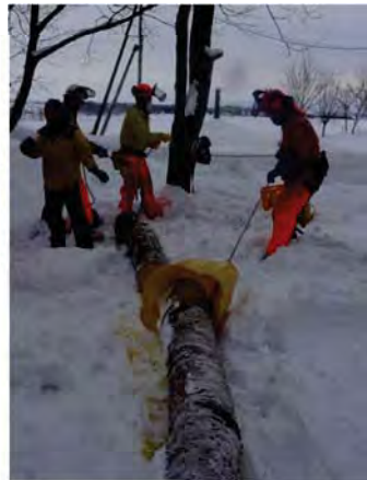
伐り出した丸太をチェーンソーで製材に (上) 小型ウィンチによる地曳き集材(左)
