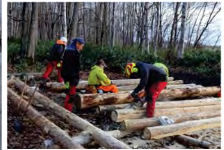
伐り出した丸太をチェーンソーで製材に (上) 小型ウィンチによる地曳き集材(左)
